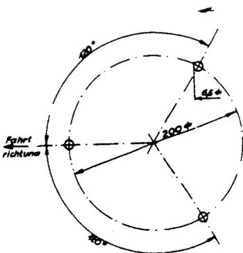
Der Sockel wird mit 3 Schrauben und Muttern M 6 auf dem Fahrzeugdach befestigt. An der hierfür vorgesehenen Stelle sind 3 Löcher mit je 6,5 mm  $\varnothing$  gemäß nebenstehendem Bohrbild zu bohren. Die Rundumkennleuchte ist so zu montieren, daß die Deckelring-schraube nach hinten, in Fahrtrichtung gesehen, zu liegen kommt. Demnach muß eines der 3 Befestigungslöcher nach vorn zu gebohrt werden (siehe Bild).
